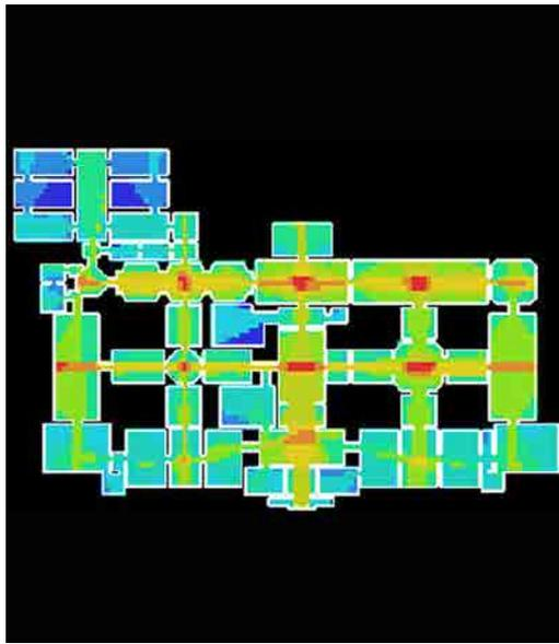
**Fig.3\_ Esempio di Visibility Graph Analysis applicata all'interno di un edificio. Da: Space Syntax\_Online Training Platform, <http://bit.ly/rVT3QA>**
